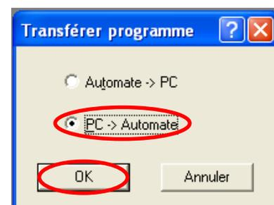
Le transfert nécessite d'arrêter l'automate, en le passant en « Stop ». A l'invite, valider le passage en « Stop » en cliquant sur « Oui ». Le transfert se fait alors et dure entre 30 et 40 secondes (voir la barre d'état).
