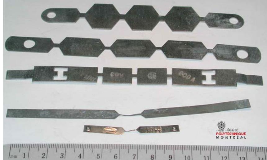
Composantes métalliques de l'intérieur de divers fusibles
