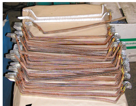
Photo N°2 : Conducteurs en cuivre en cours d'enrobage d'isolation.
