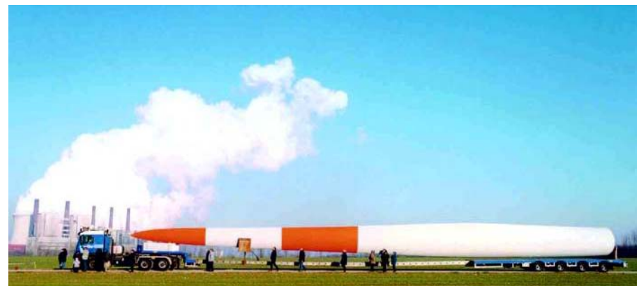
Pales de 39 m sur une Nordex N80 (2,5 MW)
