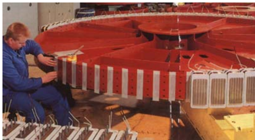
Rotor à pôles saillants bobinés Enercon
