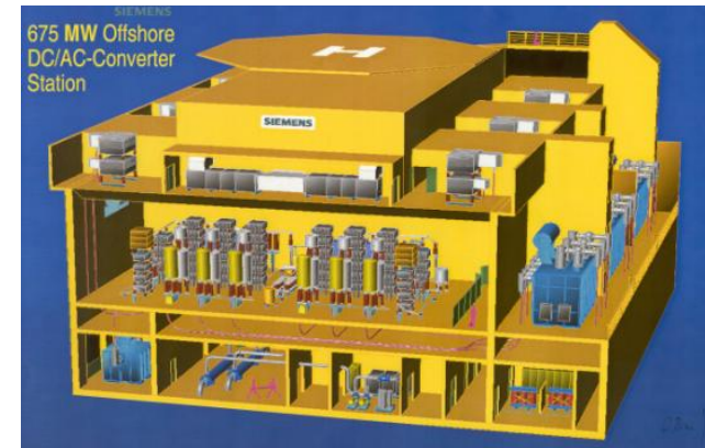
Siemens, 675 MW, 50 x 50 m 2 sur 28 m de haut
